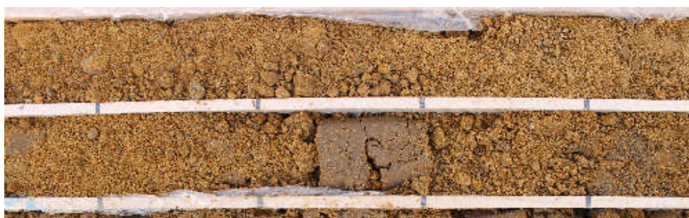
写真3. 1-2 「小諸第1火砕流堆積物(軽石多産)」の地質状況(No. 2 深度6～7m付近)
