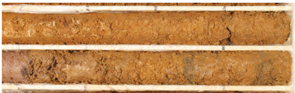
写真3. 1-3 「小諸第1火砕流堆積物(ローム質)」の地質状況(No. 1 深度2～3m付近)
