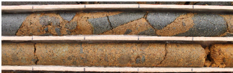
写真3.1-4 「志賀溶結凝灰岩(風化部)」の地質状況(No.3 深度7～8m付近)
