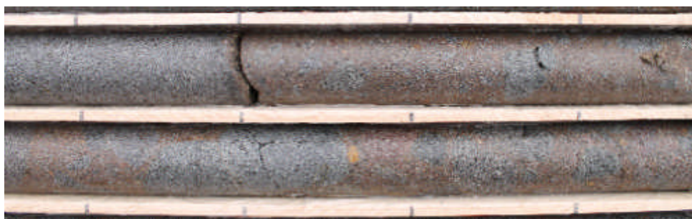
写真3.1-5 「志賀溶結凝灰岩(新鮮部)」の地質状況(No.3 深度13～14m付近)
